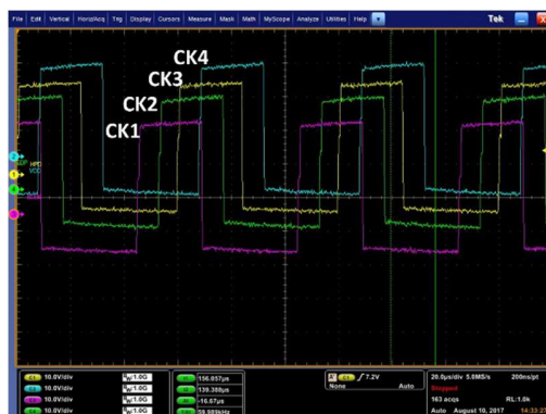
(b)TEK 示波器量测的 GOA CK 信号
